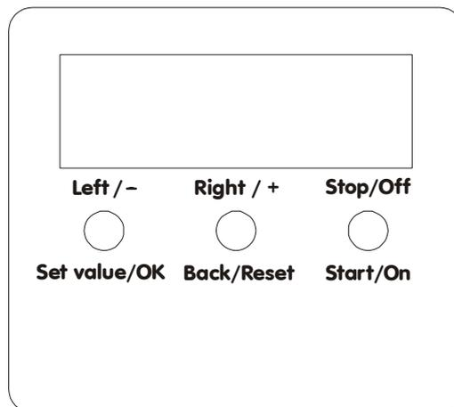
**Start/On:** Im ausgeschalteten Zustand wird durch Betätigung dieser Taste das Gerät eingeschaltet und im eingeschalteten Zustand der Dosiervorgang gestartet.
