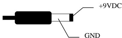
*Steckerbelegung des Netzteilsteckers*
